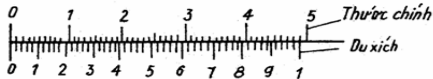
Hình 8.4 Du xích của thước cặp.
