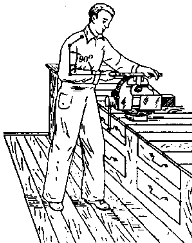
Hình 1.3. Bố trí bục công tác khi giũa
