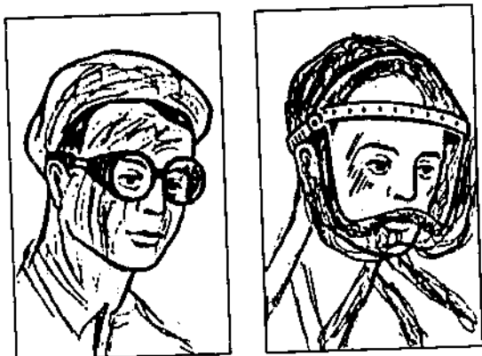
Hình 10.3. Các phương tiện bảo hiểm cho mắt a) Kính bảo hiểm ; b) Tấm chắn bảo hiểm
