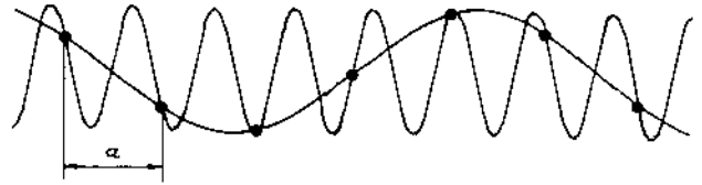
Hình 3.4. Sóng biểu diễn bởi đường liền cùng chứa thông tin như đường chấm ( \lambda \gg 2a ).
