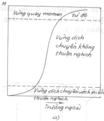
Hình 11.15. Các giai đoạn của quá trình từ hoá trong từ trường ngoài (a) và chu trình từ trễ (b): H_c - lực khử từ, trường tác dụng ngược lại để giá trị vectơ từ hoá trong mẫu bằng 0; B_r - cảm ứng từ dư khi H = 0 ; B_s - cảm ứng từ bão hoà là giá trị giới hạn của B trong trường ngoài tăng; M_s = B_s/4\pi .
