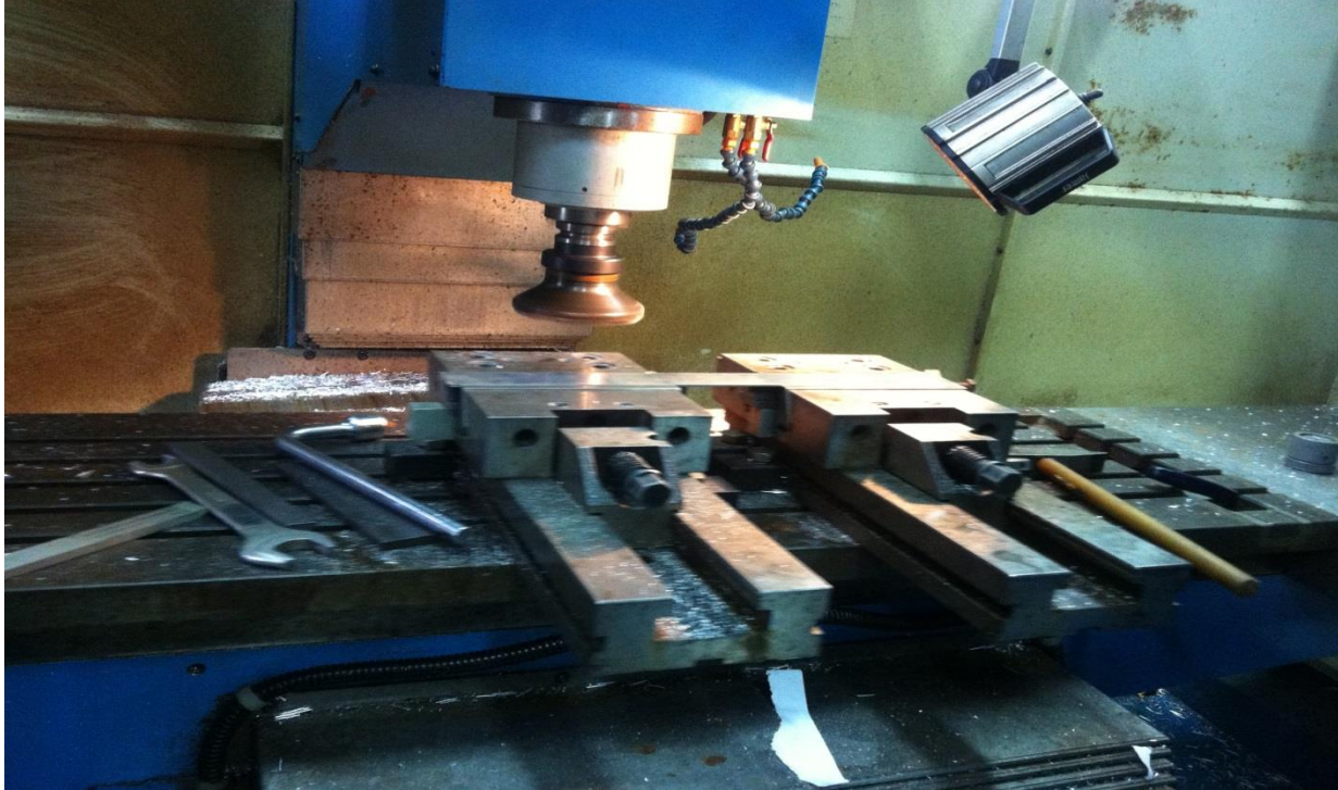
Hình ảnh phôi được gá đặt và đang trong quá trình gia công bằng dao phay chấp.
