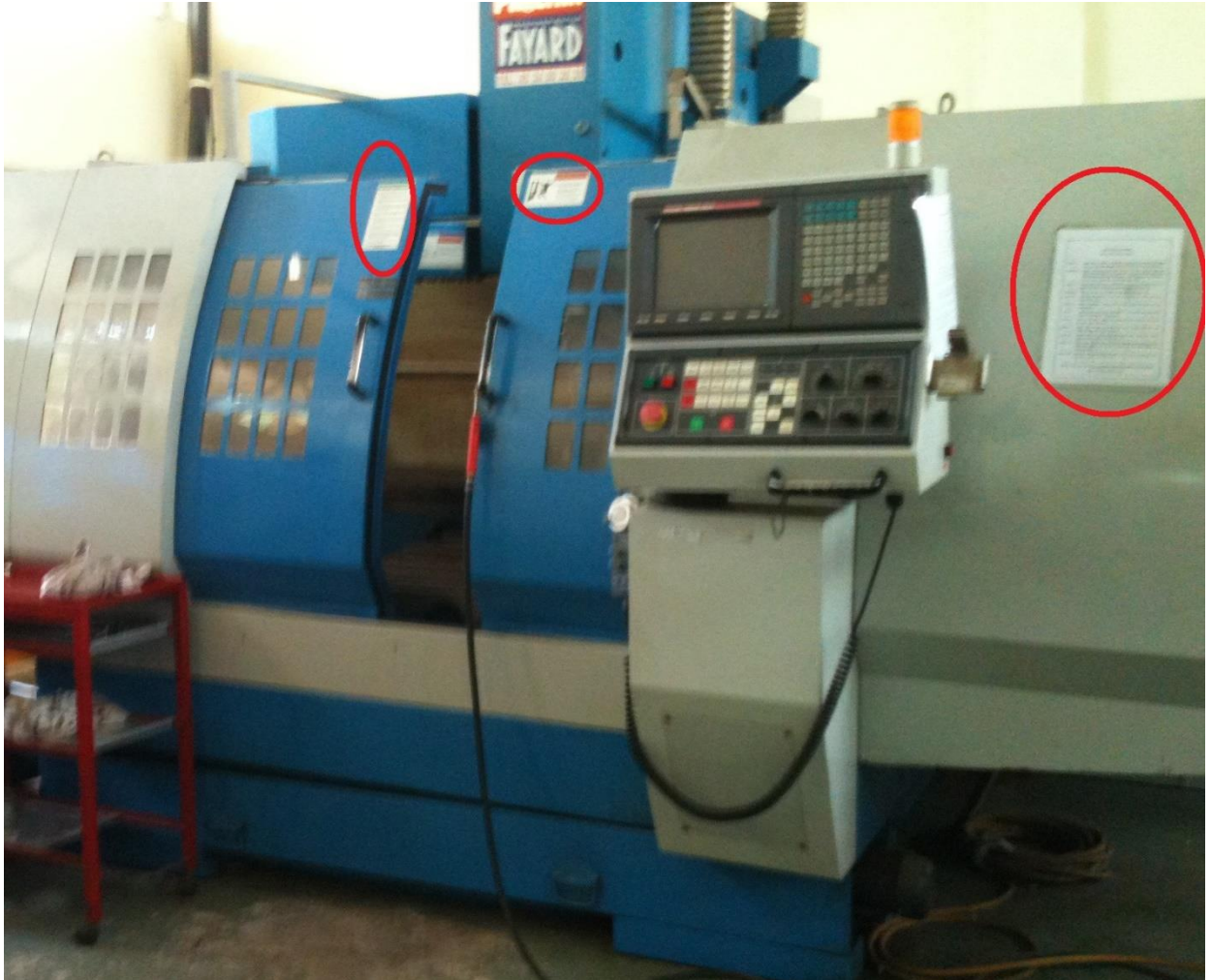
Chú ý và cách vận hành máy được dán trên vỏ máy
