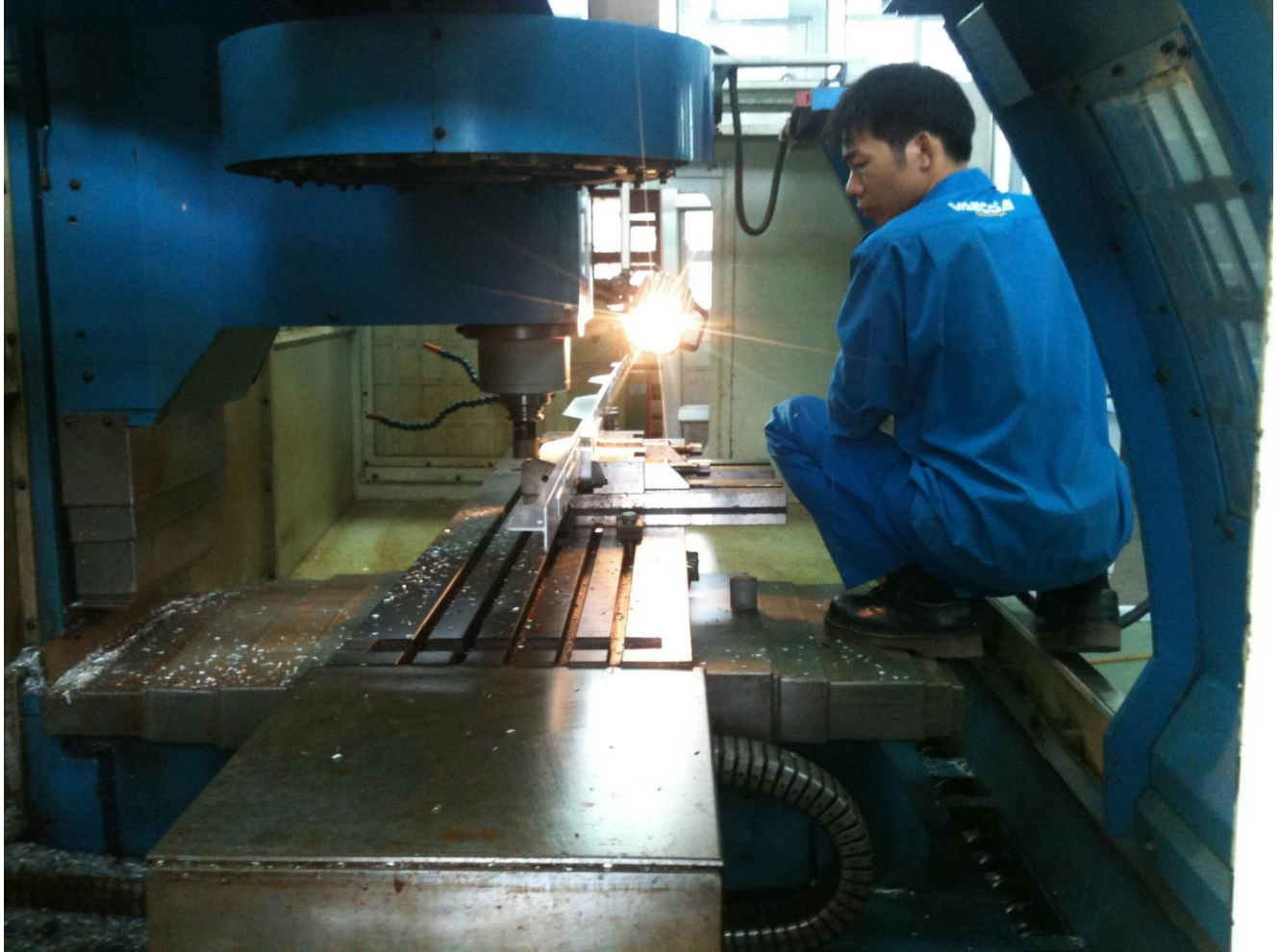
Chuyên viên đang khảo sát vị trí đặt phôi trên máy phay CNC
